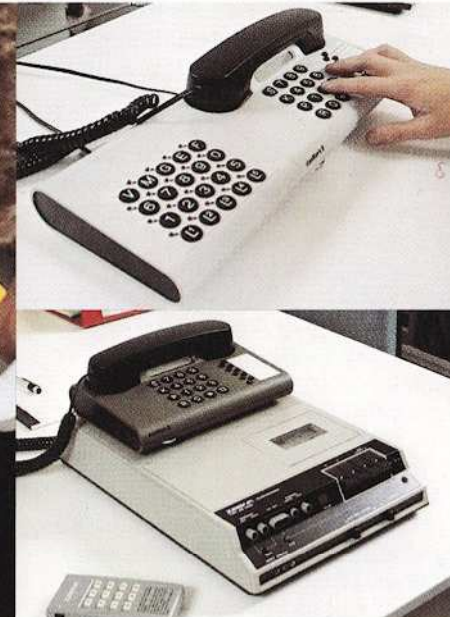
I stedet for selv at taste de mange numre, for eks. til udlandet, kan nummersenderen udføre opgaven med tryk på blot to taster.
