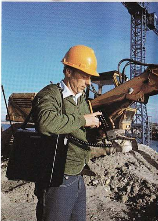
Printertelefonen er telefonen, der kan skrive det, som datamaskinen har sendt.
