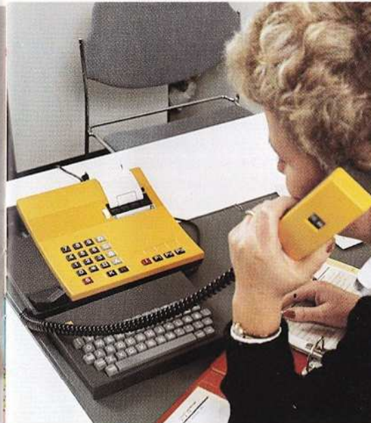
Printertelefonen er telefonen, der kan skrive det, som datamaskinen har sendt.
